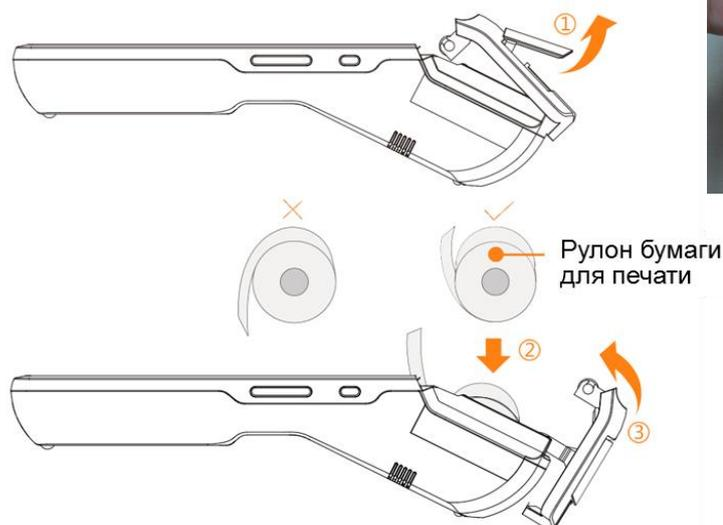
1. Крышка отсека принтера открывается с помощью ручки. Открытие крышки с применением усилия может повредить шестерни принтерной головки.
