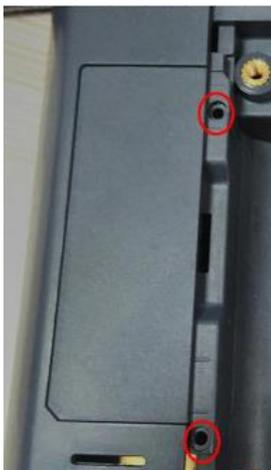
После этого открутить 2 крепежных винта крышки внутреннего отсека, предназначенного для ФН.
