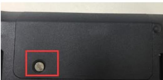
Снять крышку и вынуть батарею.
